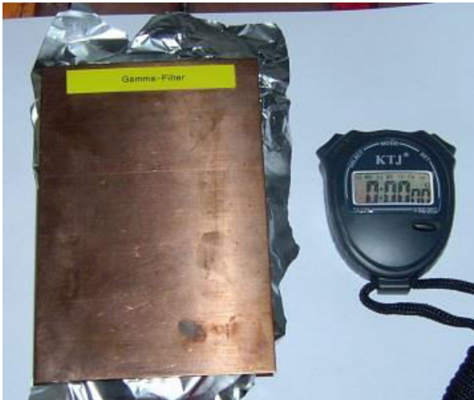
y-Messmethode mit dem YB-MM-04 Nullmessung , Messanordnung mit Gamma-Filter
