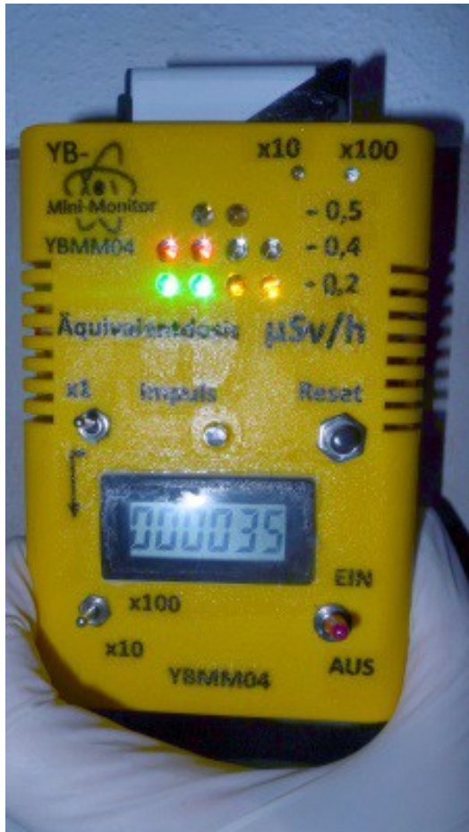
Bild: Mit dem YB-MM-04 wird Baumaterial auf Radioaktivität überprüft.
